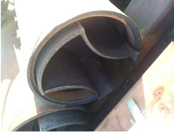
Figuur 3 Principe telescopische spudpaal type Van Wijk BV
