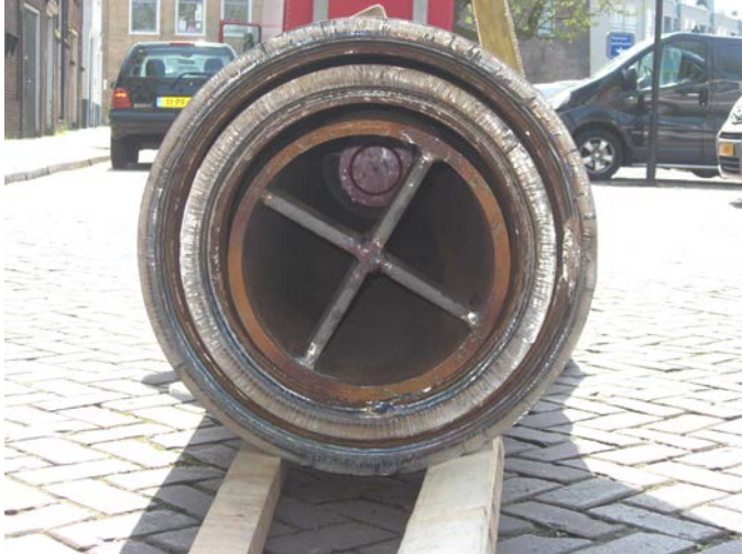
Figuur 7 Principe telescopische spudpaal type Leeuwestein Scheepsinstallaties B.V.
